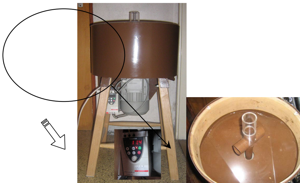
Slika 6: Drobilnik orehov z regulatorjem vrtilne frekvence (Kastelec, 2012)
